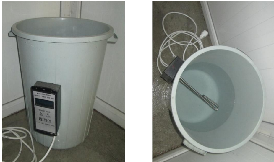
Şekil 3.10. Poliploidi uygulaması için sıcaklık şoku düzeneği
