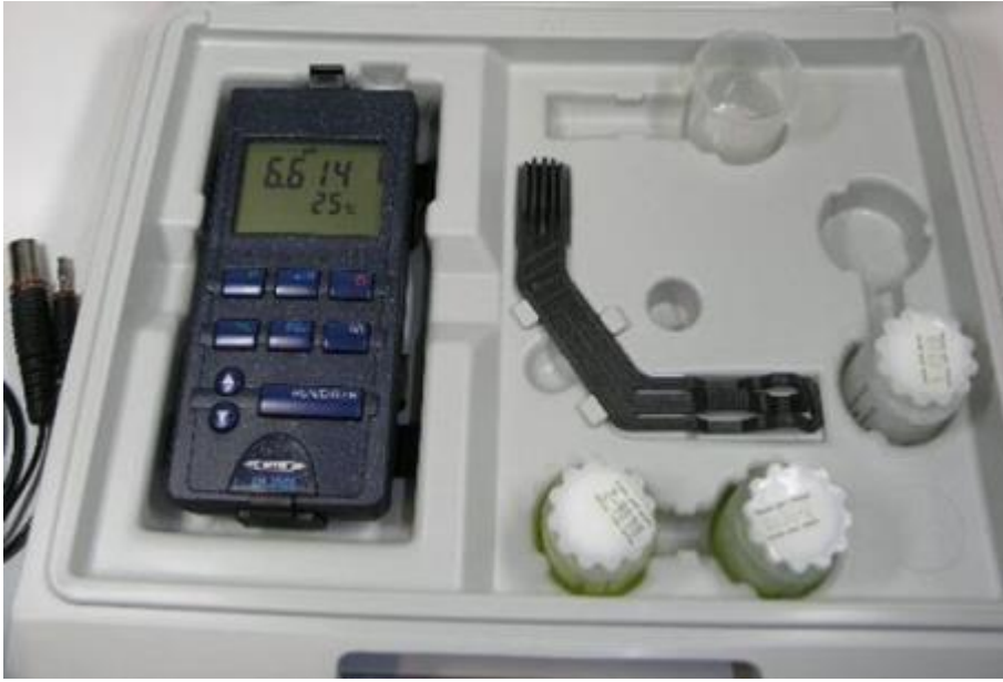
Şekil 3.7. Sıcaklık ve oksijen ölçümlerinde kullanılan oksijenmetre
