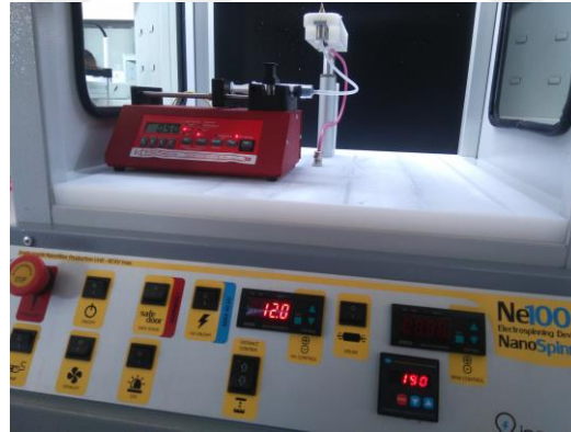
Şekil 10. Elektro eğirme (Elektrospinning) cihazı
