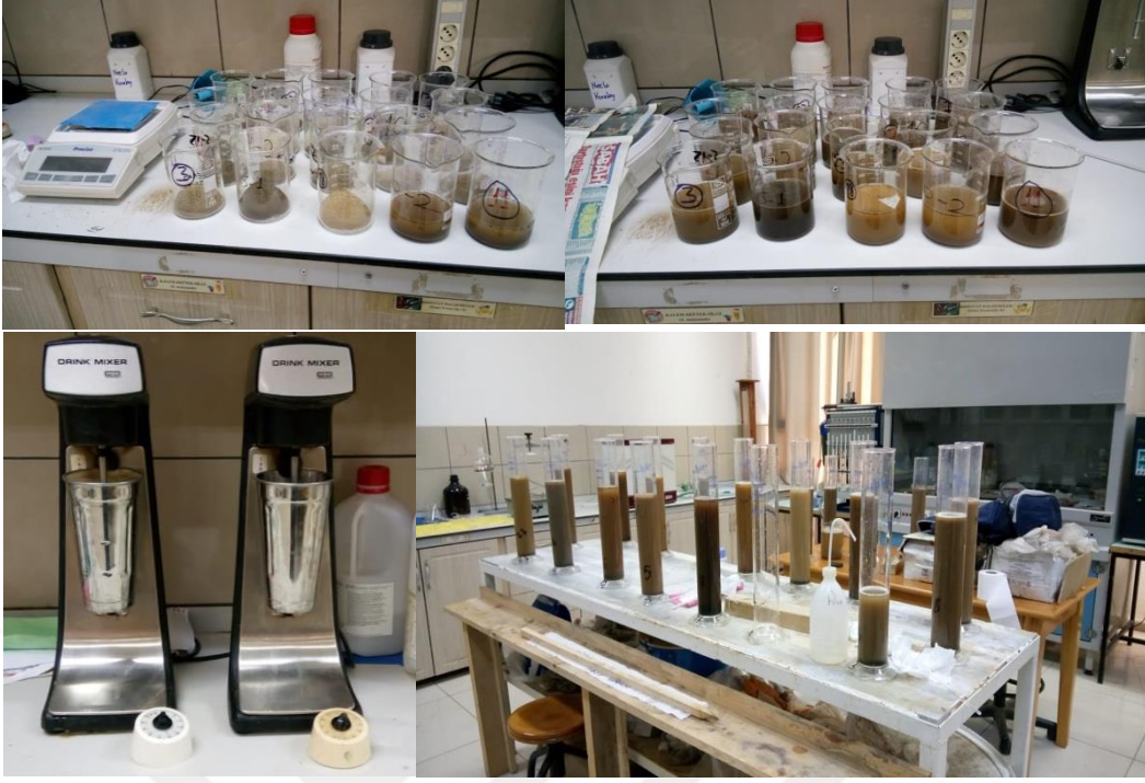
Şekil 21. Bouyoucos Hidrometre metodu
