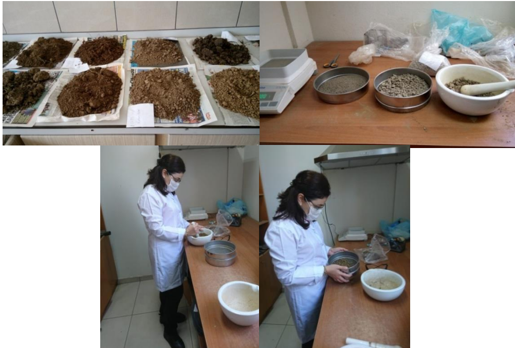
Şekil 20. Toprak örneklerinin analize hazır hale getirilmesi
