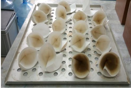
Şekil 38. Numunelerin filtre kağıdından geçirilip tartılması işlemleri
