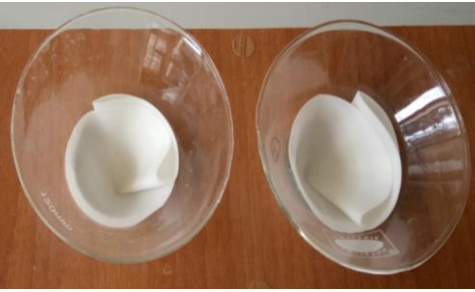
Şekil 38. Numunelerin filtre kağıdından geçirilip tartılması işlemleri
