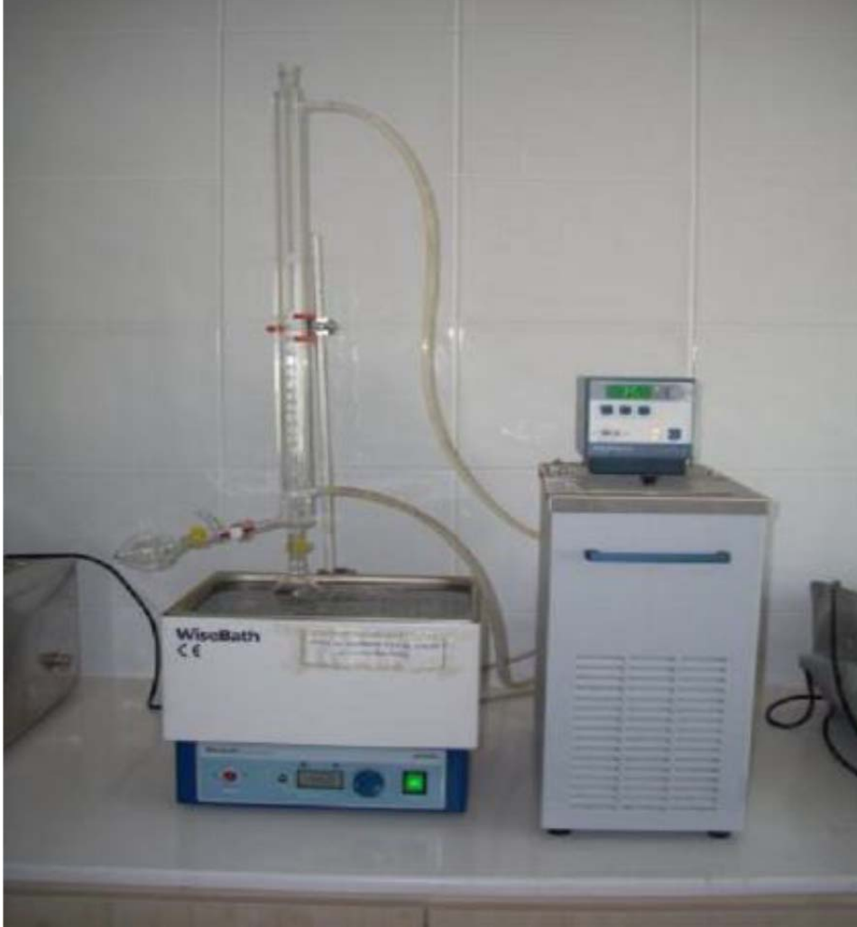
Şekil 3.5. Vigreux düzeneğinde konsantrasyon işlemi
