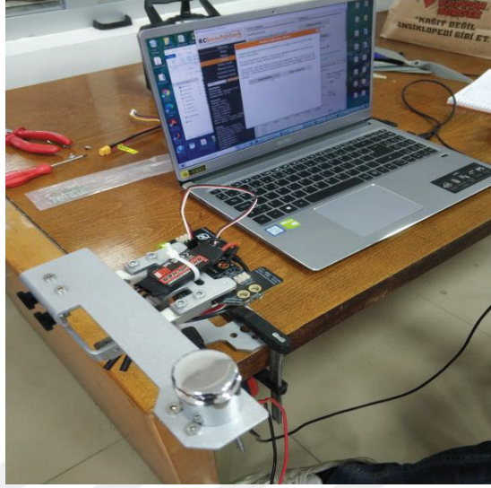
Şekil 4. 2. Kalibrasyon ağırlığı eklenmiş test cihazı.
