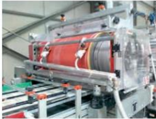
Şekil 3: Döner Elek Baskı Rotocolor [8]
