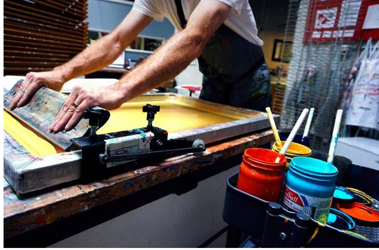
Şekil 2: Düz elek baskı [7]
