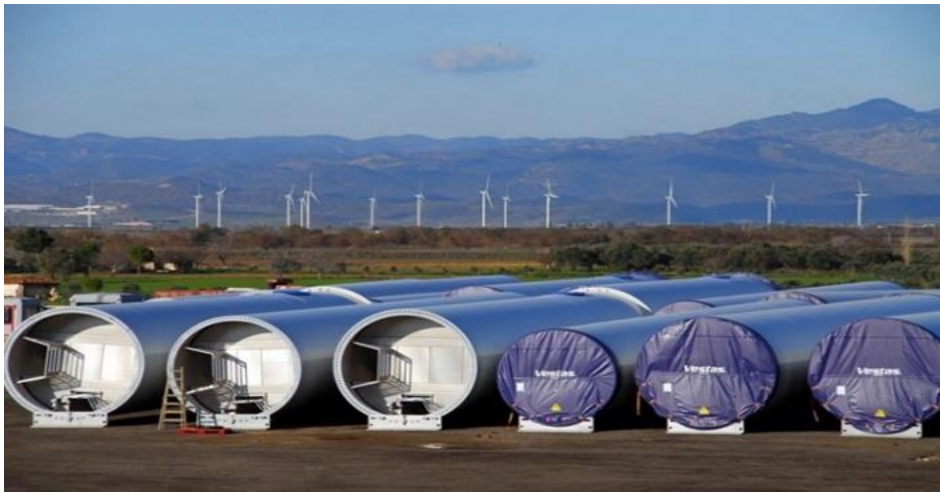
Şekil 1.26. Rüzgâr türbini kulesi (Enerji Gazetesi.ist)
