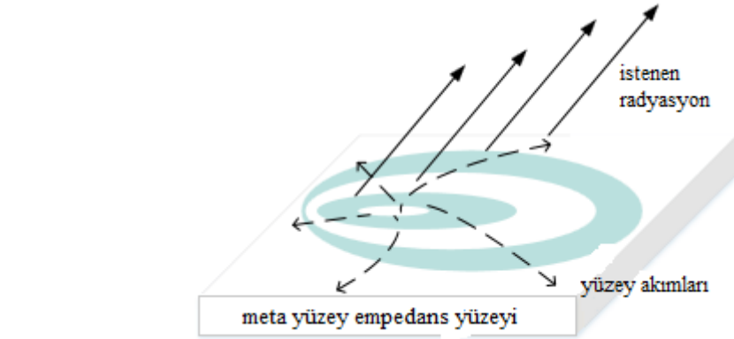
Şekil 9. Holografik empedans akıllı yüzeyinin kavramsal çizimi [71].
