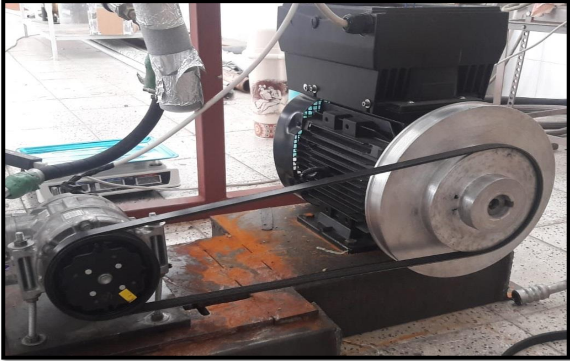
Şekil 23. Elektrik motor tahrikli araç klima sistem kompresör sistemi
