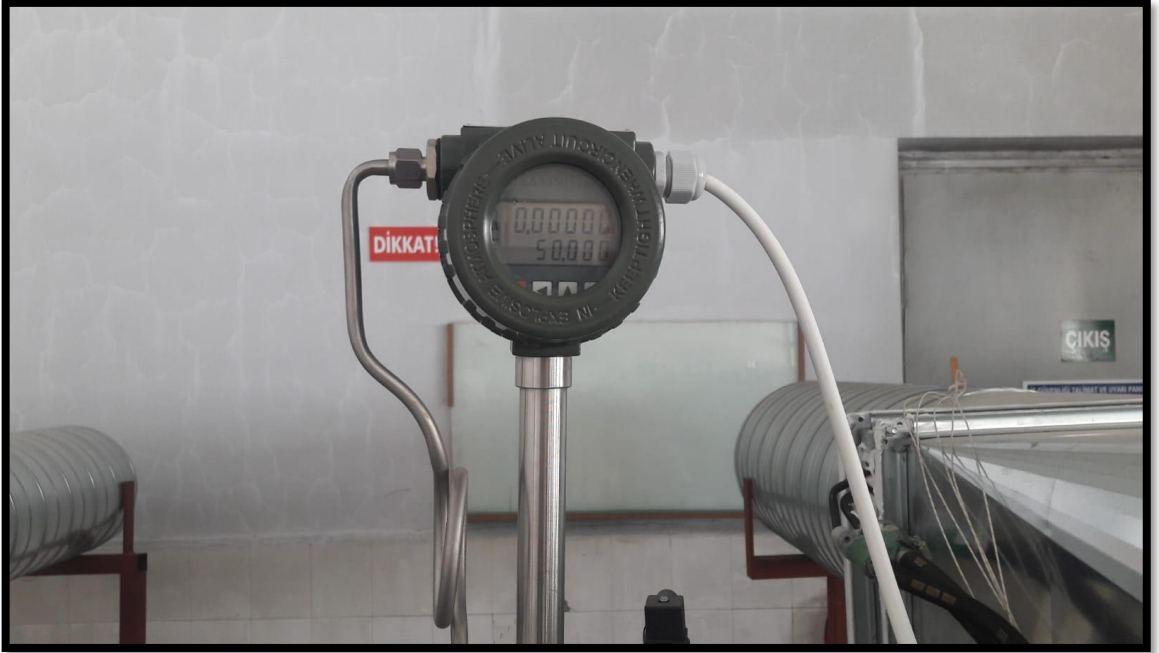
Şekil 28. Soğutucu akışkanlar için özel tasarlanmış kütleli debi ölçüm cihazı
