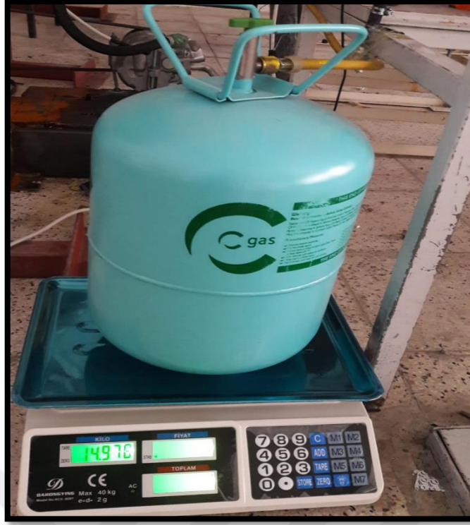
Şekil 32. Soğutucu akışkanın şarj miktarının ölçülmesi
