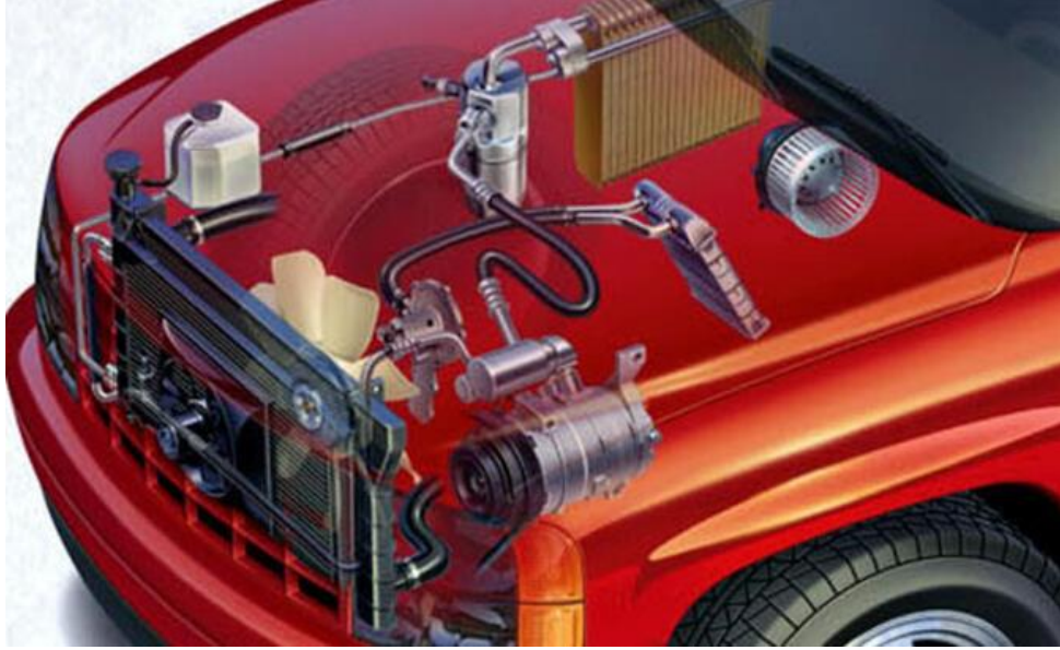
Şekil 4. Araç klima sistem yerleşimi (Milliyet, 2016)
