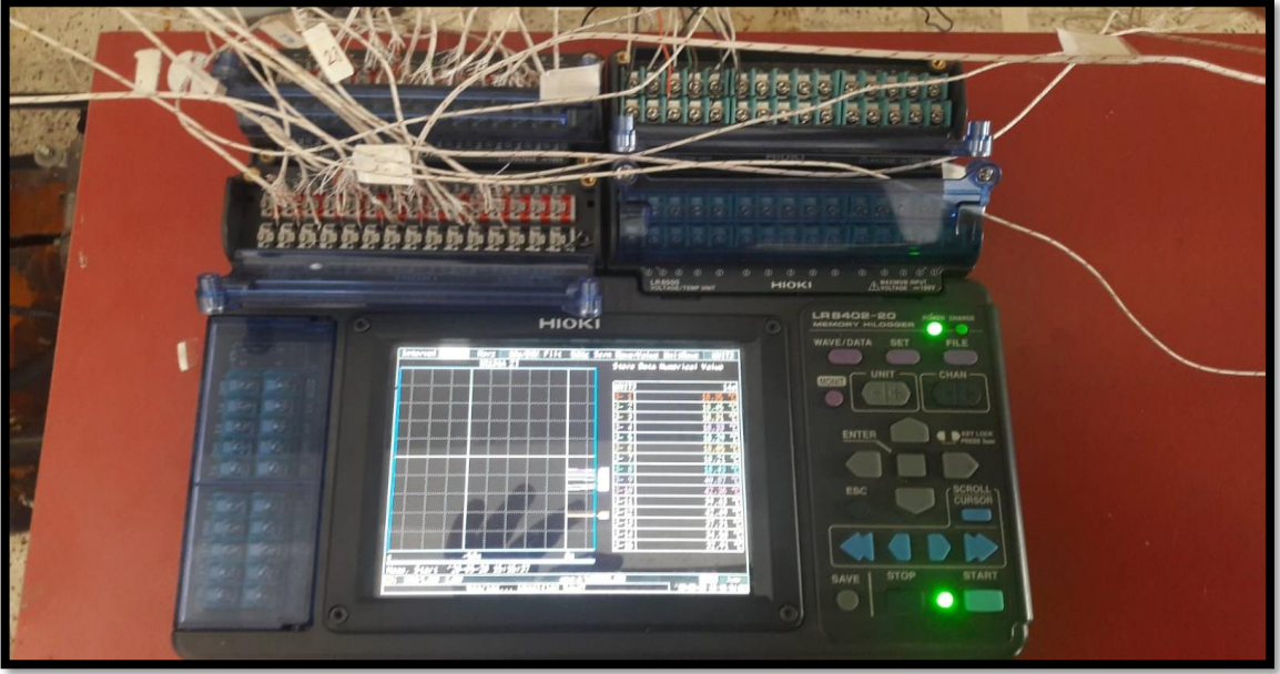
Şekil 25. HIOKI marka 60 kanal datalogger
