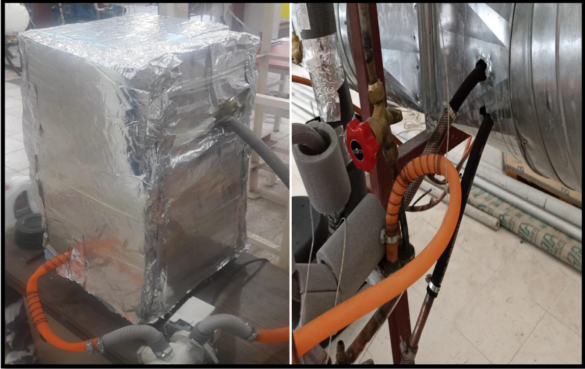
Şekil 30. Su&glikol tankı ve evaporatör bağlantısı
