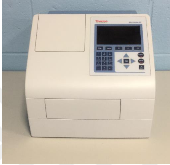
Şekil 3.9.Klorofil ölçümlerinin yapıldığı spektrofotometreden bir görünüm.
