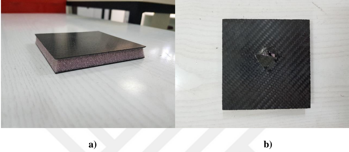
Şekil 3.12 – B-1-1 Numunesinin Darbe Öncesi ve Sonrası Durumu a) Darbe Öncesi ve b) Darbe Sonrası
