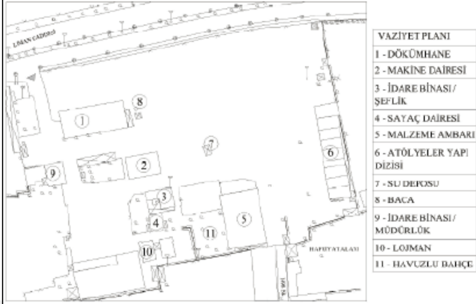
Şekil 5.19 Havagazı Fabrikası yerleşim planı (Şimşek, 2006)
