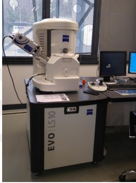
Şekil 19. Mikro yapı incelemesinde kullanılan taramalı elektron mikroskobu (SEM)
