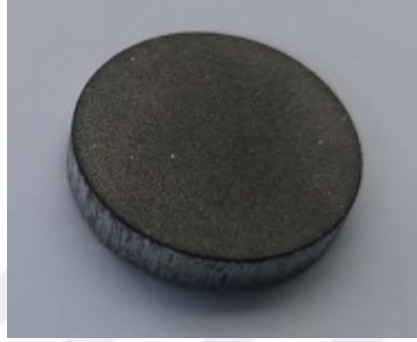
Şekil 12. Hot press haznesinden çıkarılan bir MgB_2 örneği
