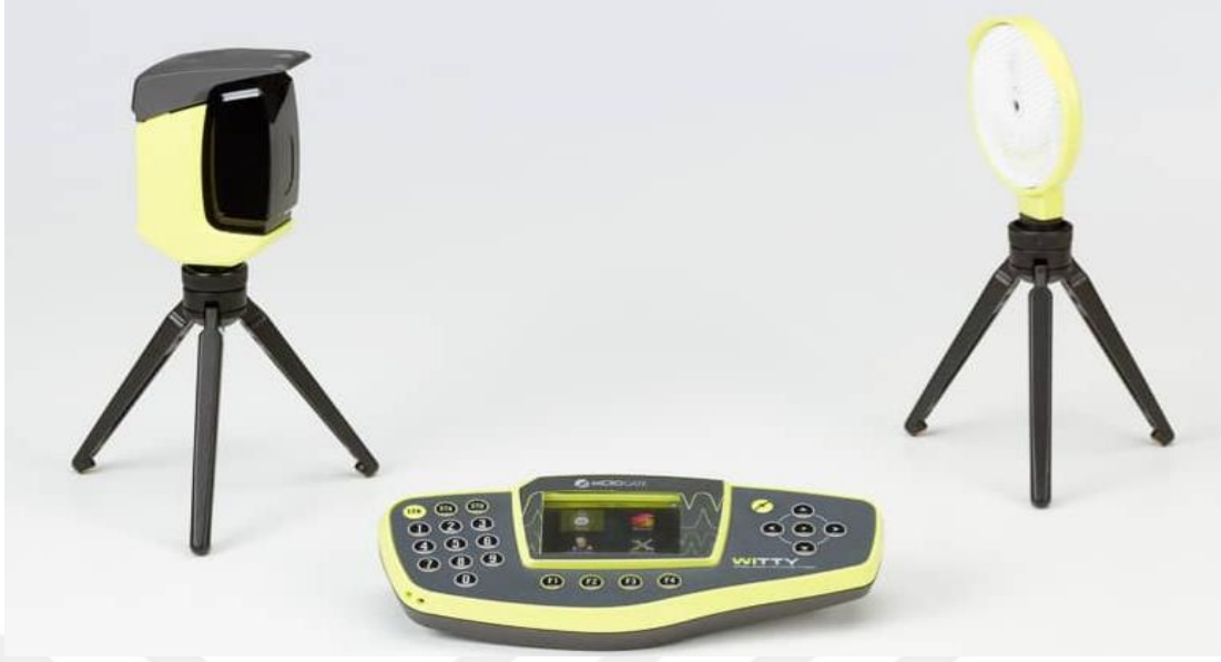
Resim 8. Dikey sıçrama testi için kullanılan ölçme değerlendirme cihazı ( https://www.elsa.web.tr/tr/urun/performans-olcum-ve-analiz/telemetrik-kronometre-focell/microgate-witty-photocell , Erişim Tarihi: 01.09.2022).
