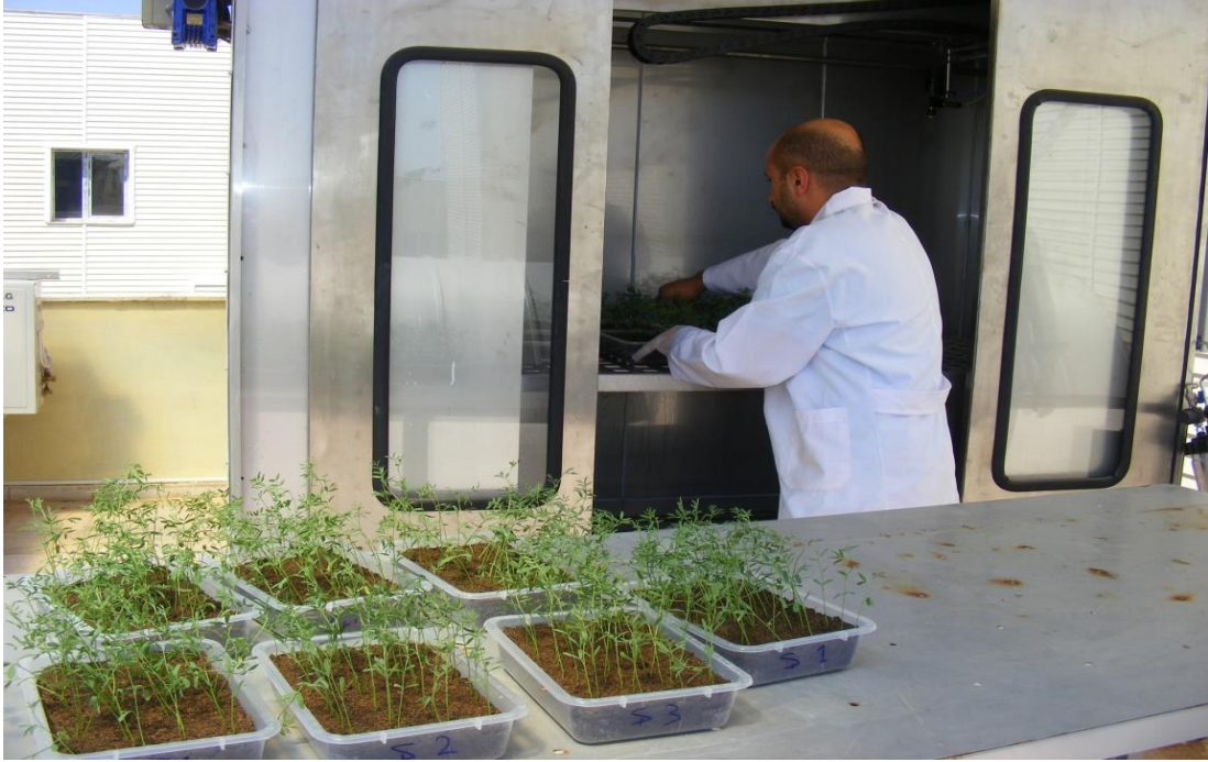
Şekil 3.5. Tam otomasyonlu herbisit uygulama kabininde İmazamox uygulaması
