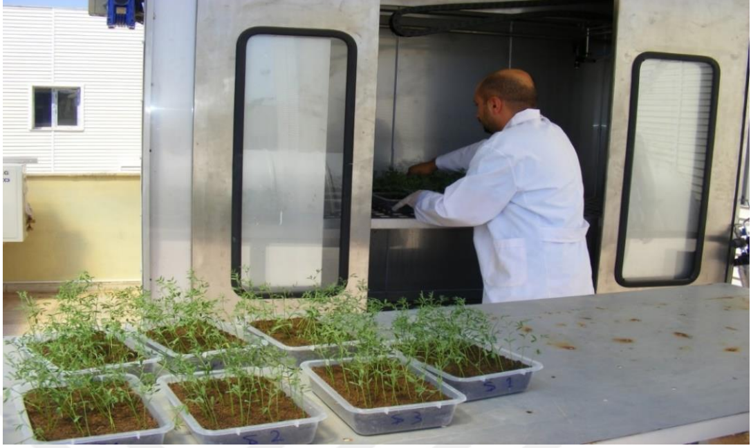
Şekil 3.2. Herbisit uygulamalarının yapıldığı tam otomatik uygulama kabini
