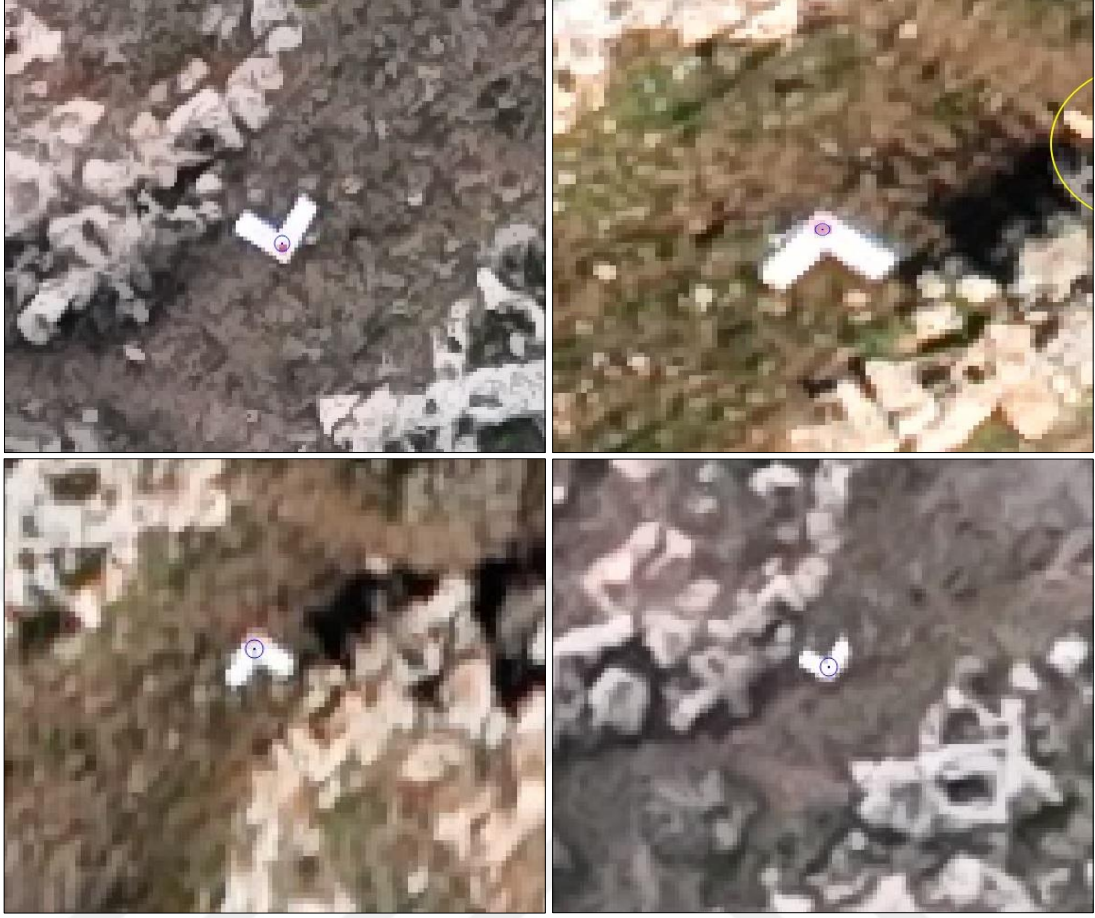
Şekil 4.6: Arazi noktalarının ortofotolar üzerindeki görünümü
