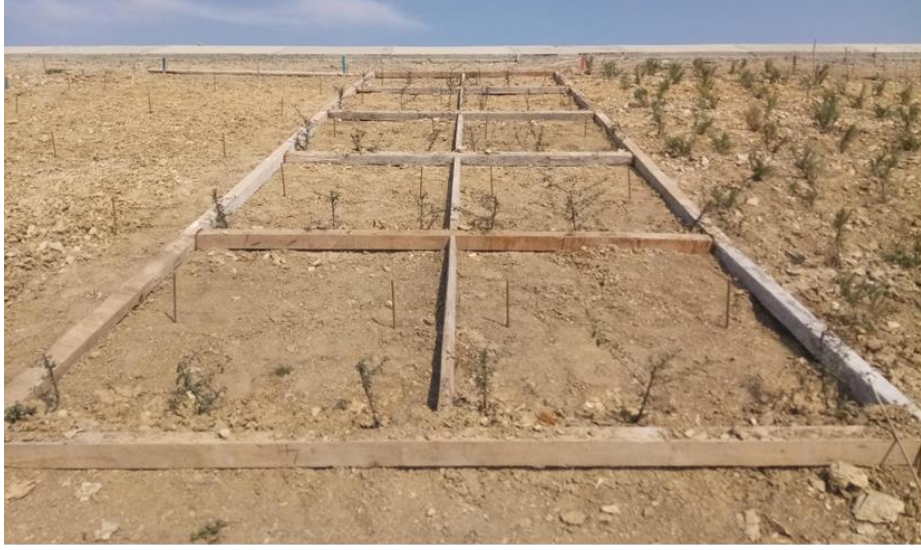
Şekil 3.15: Erozyon çubuklarının deneme parsellerine yerleştirilmesi; planı(a) görünümü (b).
