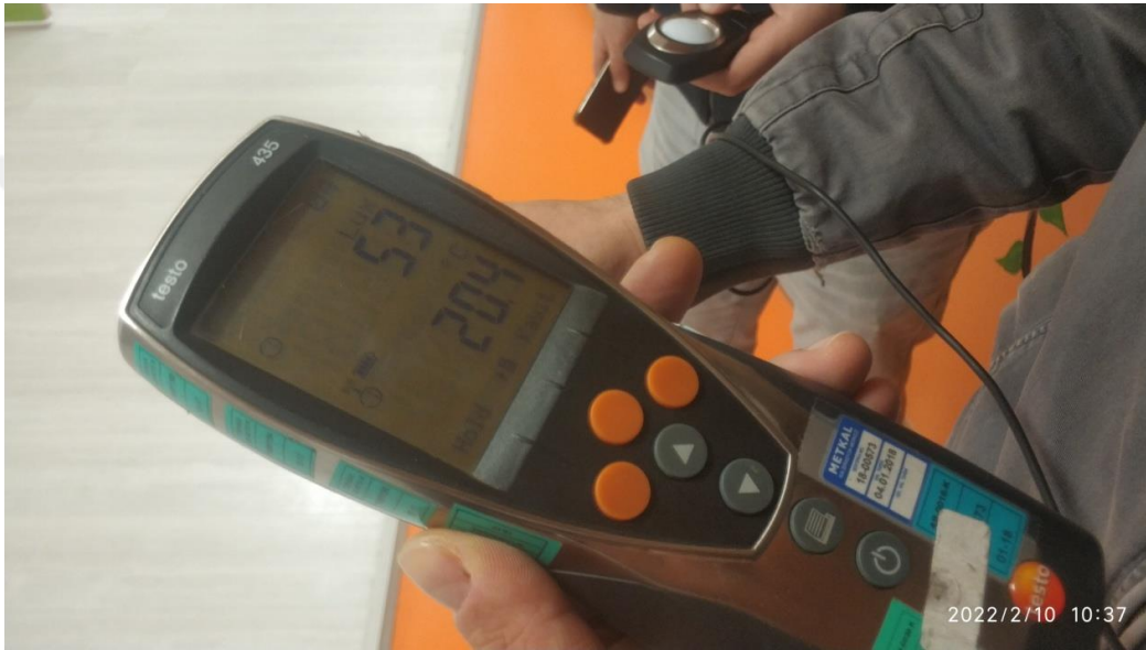
Görsel 5.15: Aydınlık Şiddeti ve İç Ortam Sıcaklık Ölçümü
