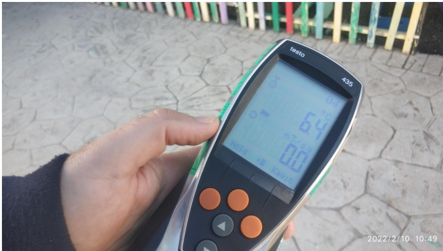
Görsel 5.18: Dış Ortam Sıcaklık Ölçümü
