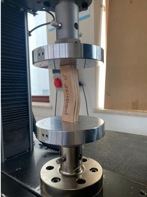
Resim 4.7. Basınç dayanımı deney düzeneği
