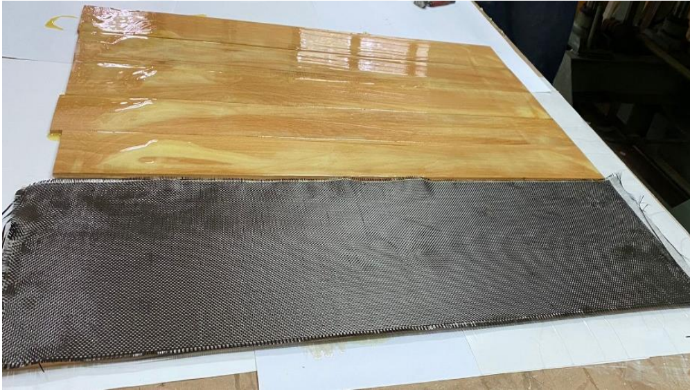
Resim 4.4. Sarıçam, poliüretan tutkal, karbon fiber kumaş kombinasyonu
