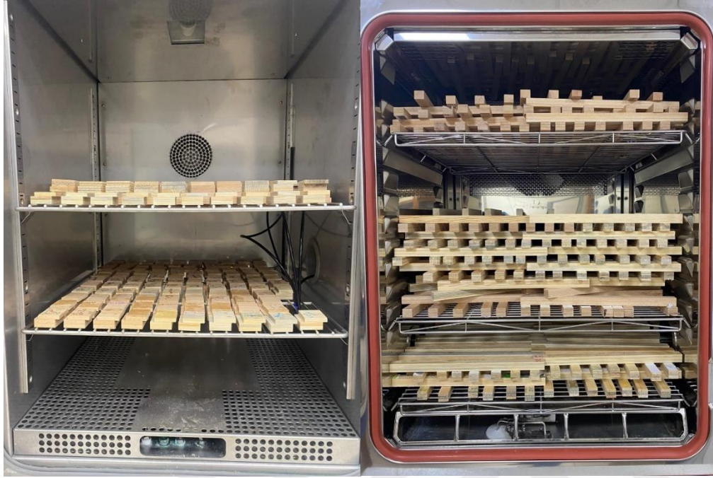
Resim 4.5. Deney örneklerinin deneylerden önce kondüsyonlanması (a, b)
