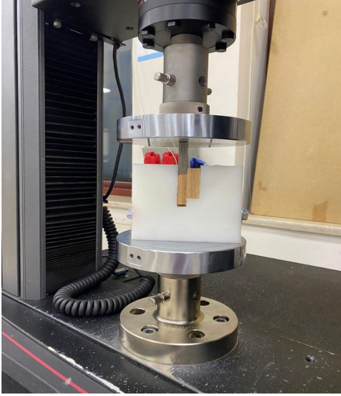
Resim 4.9. Makaslama dayanımı deney düzeneği
