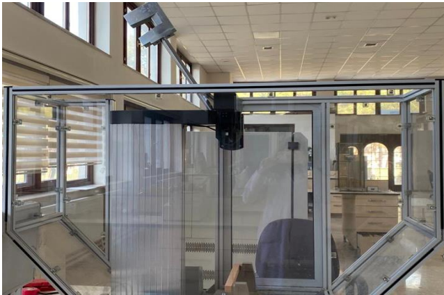
Resim 4.8. Dinamik eğilme dayanımı deney düzeneği
