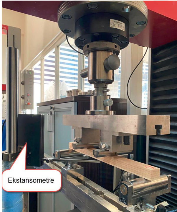
Resim 4.6. Eğilmede elastikiyet modülü deney düzeneği
