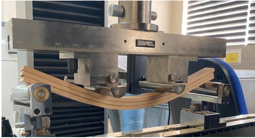
Resim 6.1. Karbon fiber kumaş destek katmanlı örnekte deformasyon durumu
