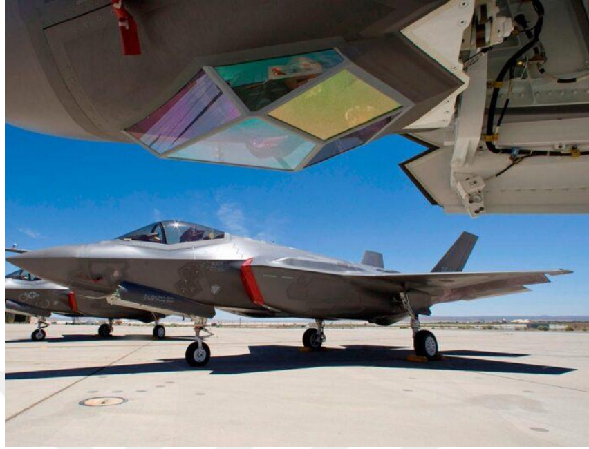
Şekil 9.28 F-35 Uçağına ait Elektro-Optik Hedefleme Sistemi
