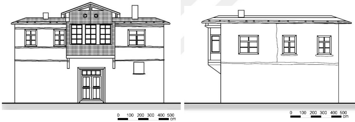
Şekil 59. İsa Çoban Evi şematik ön ve sağ yan cephe rölöve çizimleri
