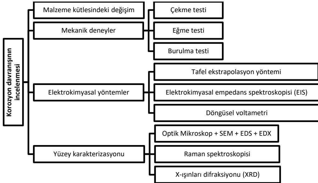
Şekil 4.1 Korozyon davranışını inceleme yöntemleri
