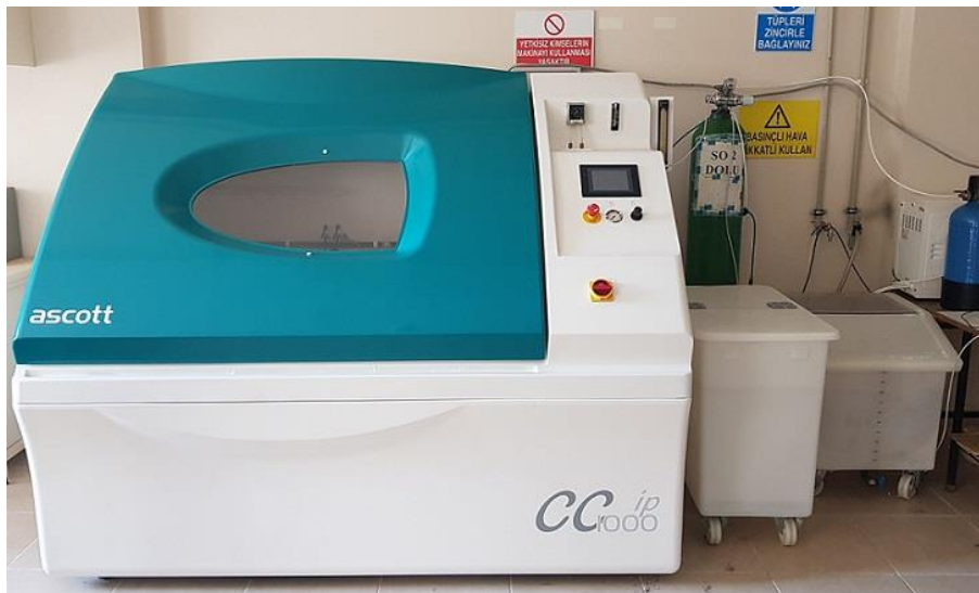
Şekil 4.3 Kullanılan yaşlandırma test cihazı (Kişisel arşiv, 2016)
