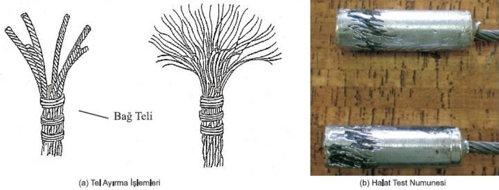
Şekil 4.12 Çinko dökm ve bağ teli yöntemiyle halat numunesinin hazırlanması (İmrak ve Salman, 2010)
