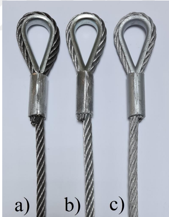
Şekil 4.23 Çelik tel halatların korozyon tedbirleri bakımından karşılaştırılması a) Galvanizlenmemiş b) Sıcak daldırmayla galvanizlenmiş c) Epoksi astar ile boyanmış (Kişisel arşiv, 2021)
