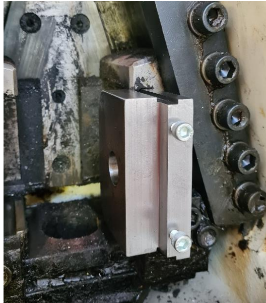
Şekil 4.15 Yeni tip halat numunesine uygun tasarlanıp üretilen çekme çenesi (Kişisel arşiv, 2021)
