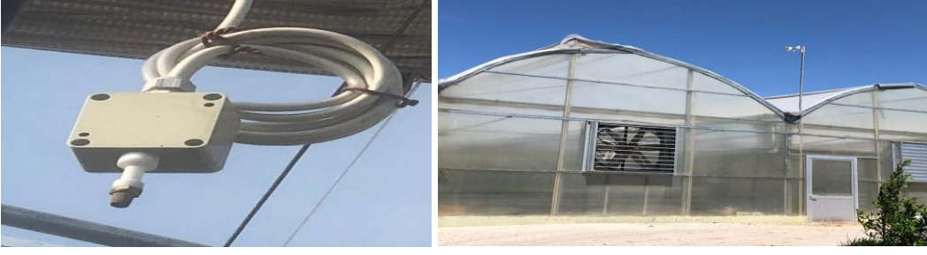
Şekil 3.48. Sera içi ve dışında bulunan iklim verileri toplama sensörleri
