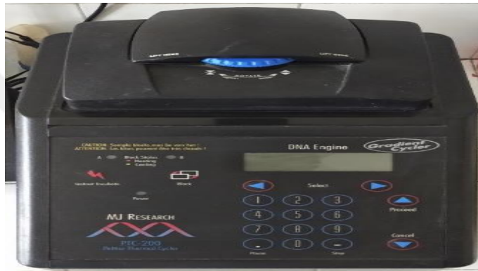
Şekil 3.26. PCR işleminin gerçekleştirildiği MJ Research – PCT 200 cihazı
