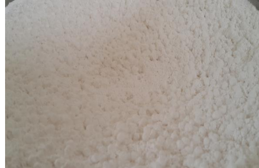
Şekil 3.13: Ekstrüzyon öncesi granül ve toz maddelerin karışımı
