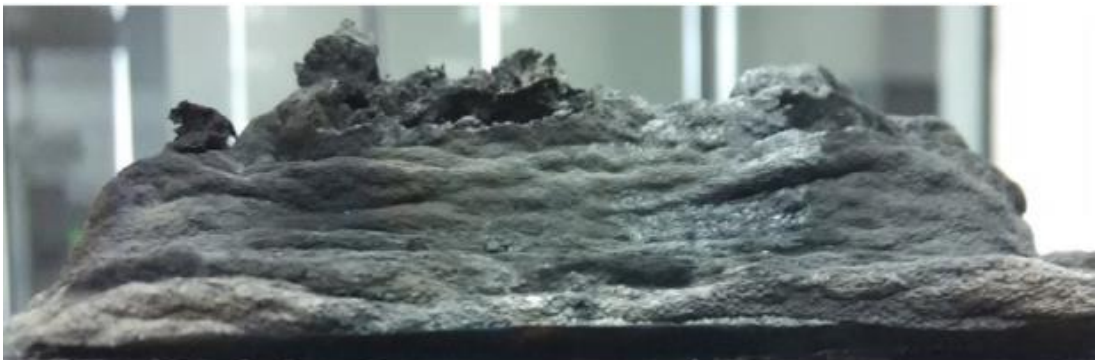
Şekil 2.3: Polimer malzemenin yüzeyinde oluşan kabaran karbon tabakası (Feng ve diğ. 2016)
