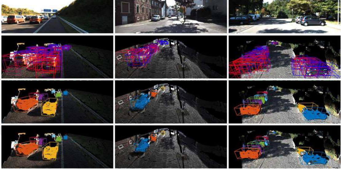
Şekil 2.2: Kamera ve LIDAR Verisinin Birlikte Kullanımıyla Araç Tespiti.
