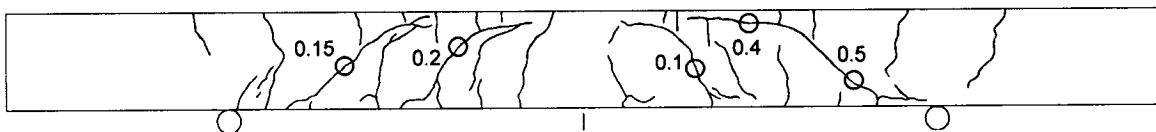
(d) Observed crack profile (west face)
