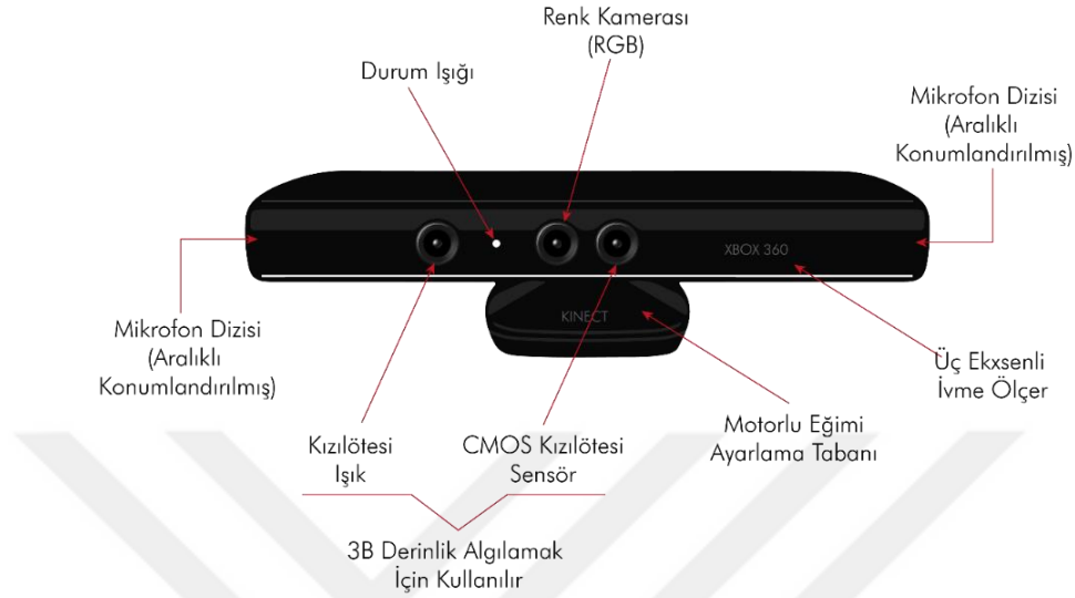
Şekil 1. Kinect v1'in dış donanım özellikleri
