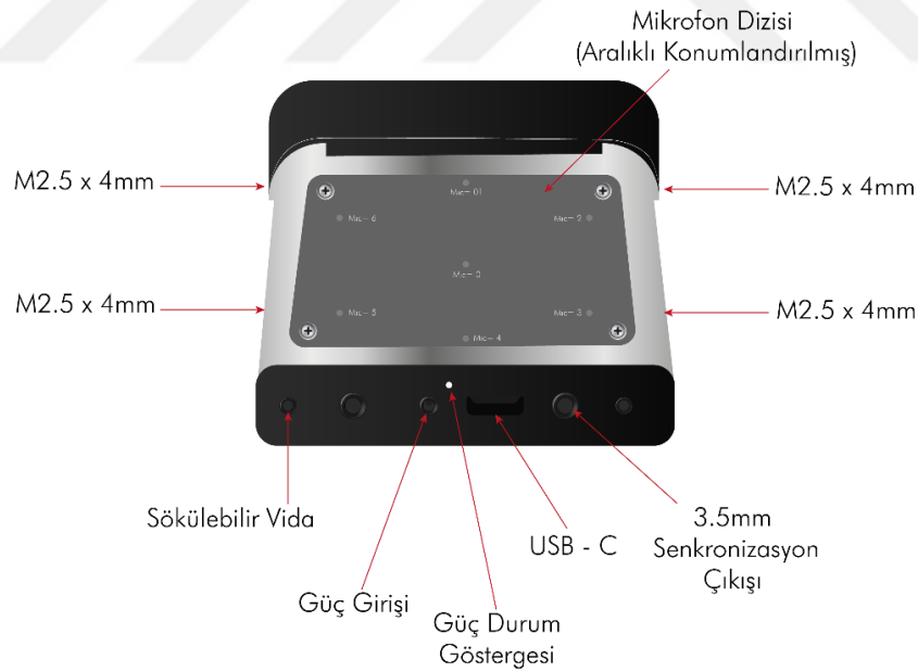
Şekil 7. Kinect v3'ün (Azure Kinect DK) iç donanımı
