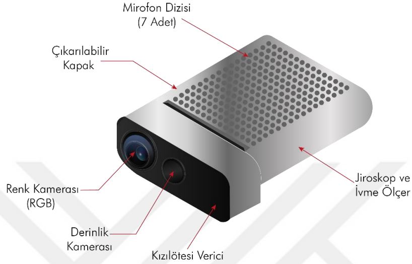
Şekil 7. Kinect v3'ün (Azure Kinect DK) iç donanımı
