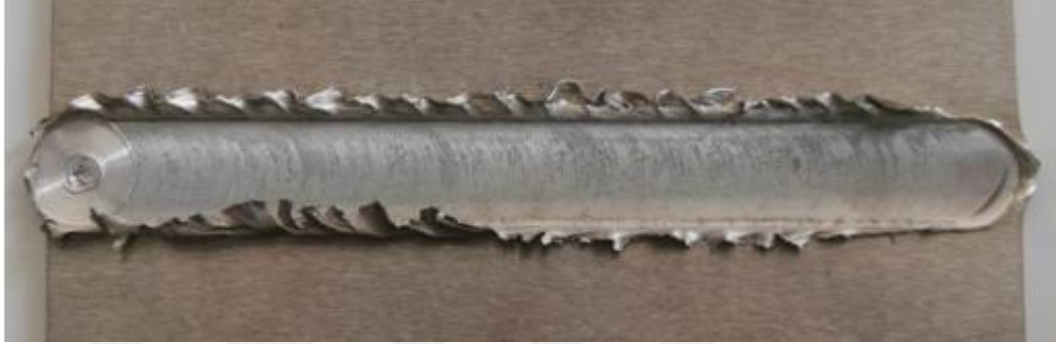
Şekil 8.9: 1600 rpm 400 mm.min -1 kaynak parametresi üst yüzey görünümü.
