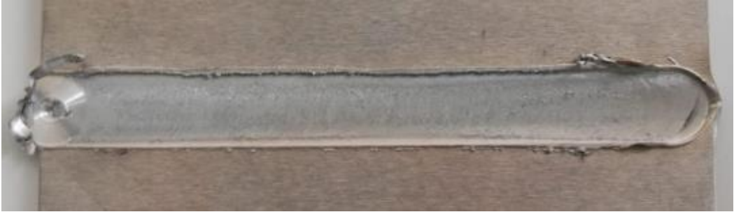
Şekil 8.6: 1600 rpm 500 mm.min -1 kaynak parametresi üst yüzey görünümü.
