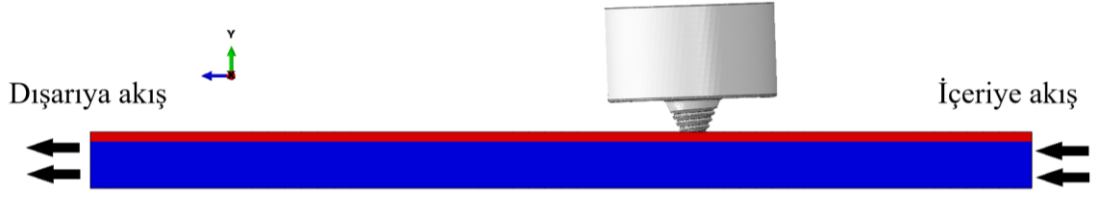
Şekil 7.13: Sayısal modeldeki malzeme akışı.
