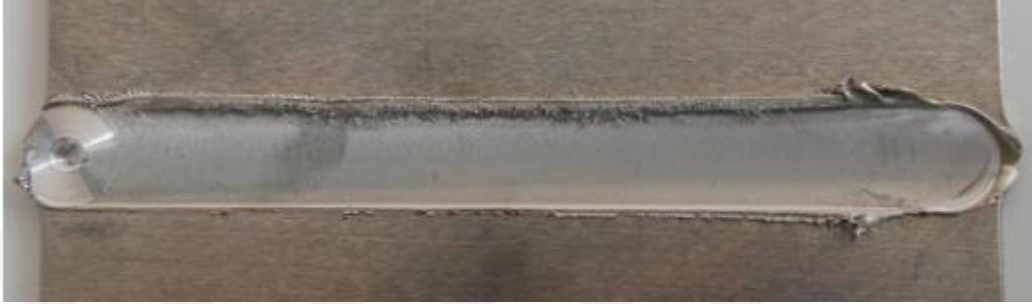
Şekil 8.5: 1250 rpm 600 mm.min -1 kaynak parametresi üst yüzey görünümü.
