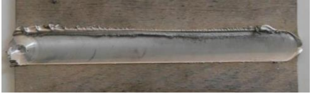
Şekil 8.8: 1000 rpm 300 mm.min -1 kaynak parametresi üst yüzey görünümü.
