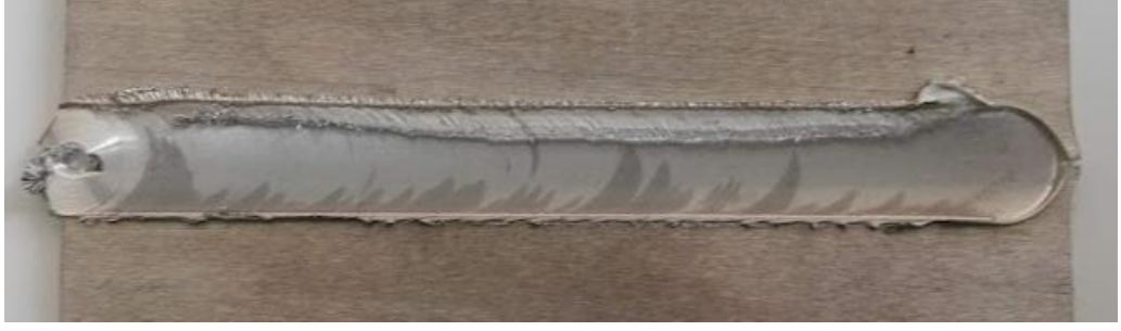
Şekil 8.4: 1000 rpm 500 mm.min -1 kaynak parametresi üst yüzey görünümü.
