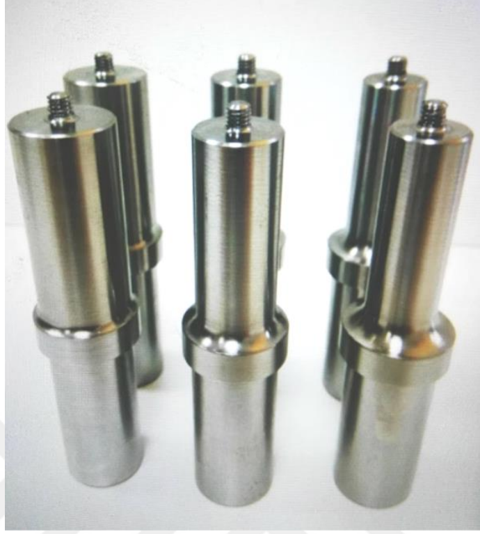
Şekil 7.3: Takımların ısıtım işlem öncesi fotoğrafı.
