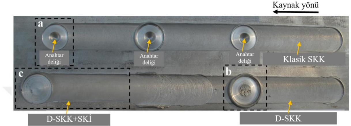
Şekil 4.11: SKK ve D-SKK’lı plaka a) SKK anahtar deliği kusurları, b) D-SKK ile onarılan anahtar deliği, c) D-SKK+SKİ’den sonra onarılan anahtar deliği (Han ve diğ. 2013).
