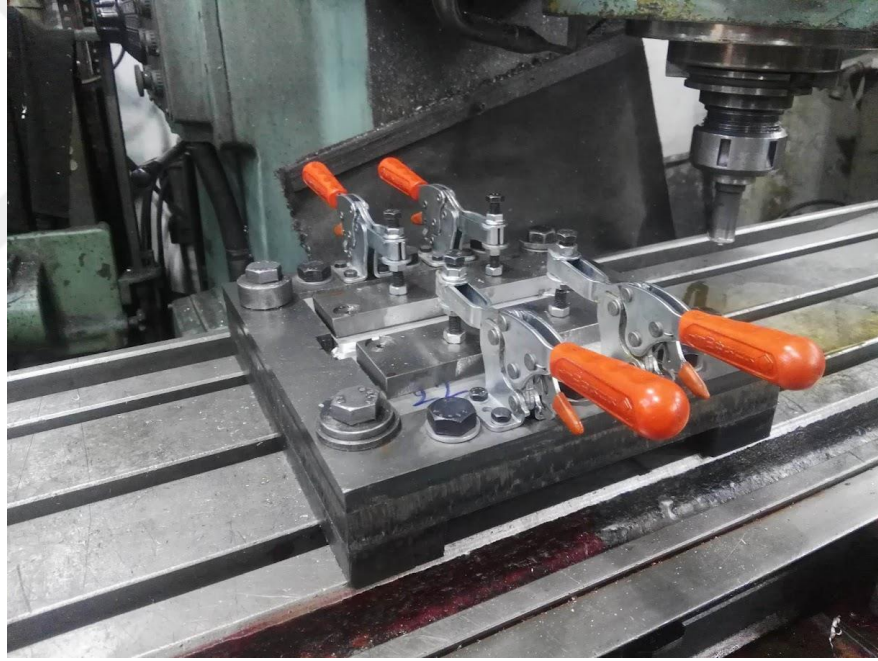
Şekil 7.1: Malzeme tutucu kalıp a) 3B modeli, b) Montajlanmış hali.
