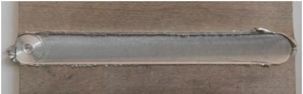
Şekil 8.7: 1250 rpm 400 mm.min -1 kaynak parametresi üst yüzey görünümü.
