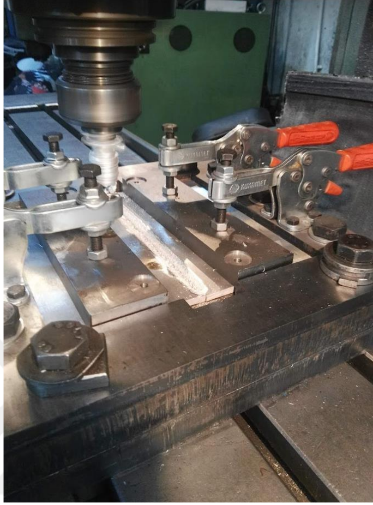
Şekil 8.1: 15 mm omuz çapına sahip takımda malzemenin takıma sıvanması.
