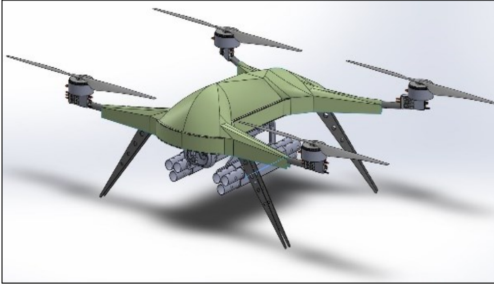
Şekil 3.3. Taktik silahlı mini insansız hava aracı konsept tasarımı
