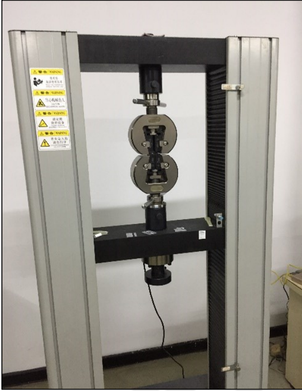
Resim 3.2. Deneyde kullanılan çekme cihazı
