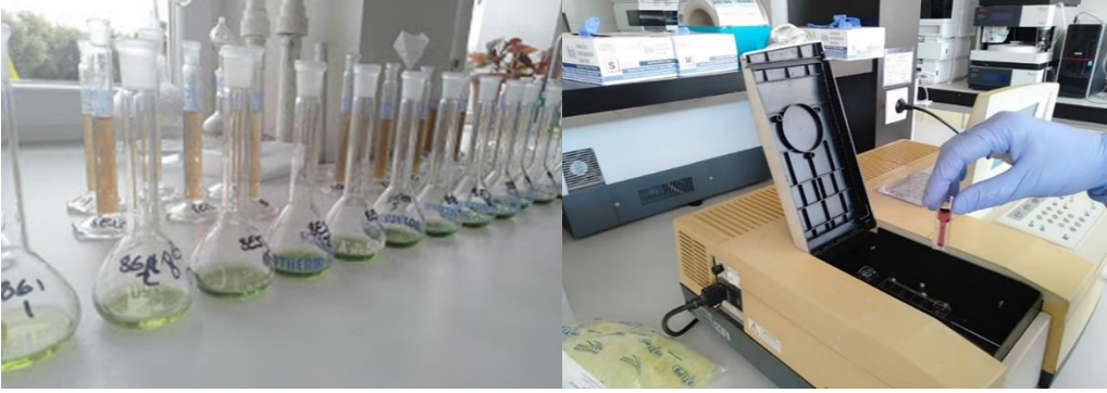
Şekil 3.3.4. Toplam fenolik madde tayini için hazırlanan ekstraksiyonlar (a) spektrofotometre cihazı (b).
