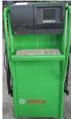
Şekil 5.6. Egzoz emisyon ölçüm cihazı
