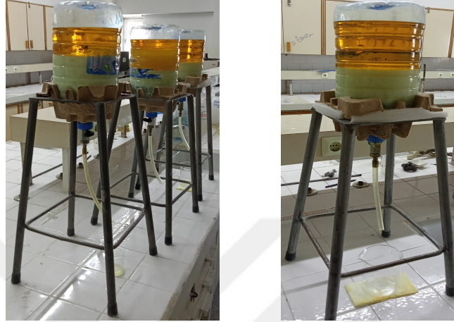
Şekil 5.4. Badem metil ester yıkama işlemi
