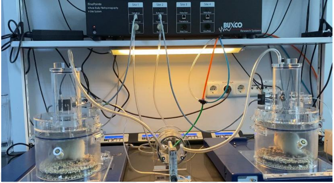
Şekil 3.1. Ventilasyon ölçümlerinin yapılacağı bütün vücut pletismografi (WBP) sistemi.
