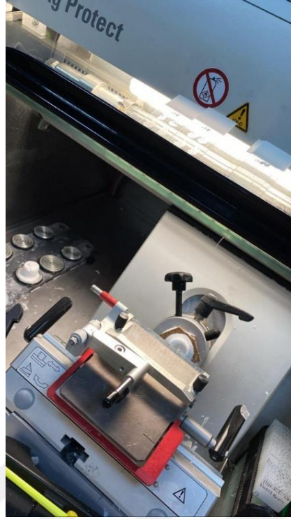
Şekil 3.4. Donduruculu karyostat kullanılarak -20^{\circ}\text{C} derecede 20\ \mu\text{m} kalınlığında transvers kesitler alınma işlemi.
