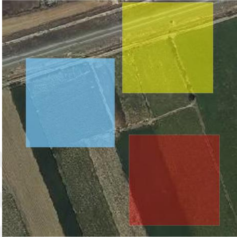
Şekil 40. Örnek bir görüntü üzerinde karşılaştırma metrik değerlerini oluşturan doğru pozitif, yanlış pozitif ve yanlış negatif değerlerinin gösterimi
