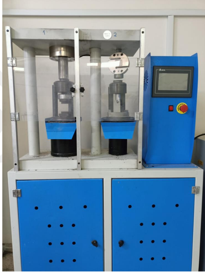
Şekil 10. Eğilme-basma test cihazı
