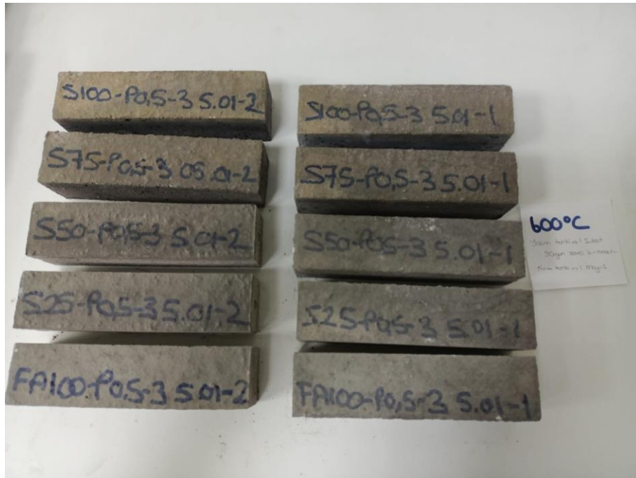
Şekil 44.600°C yüksek sıcaklık sonrası %0,5 polipropilen lif takviyeli numuneler
