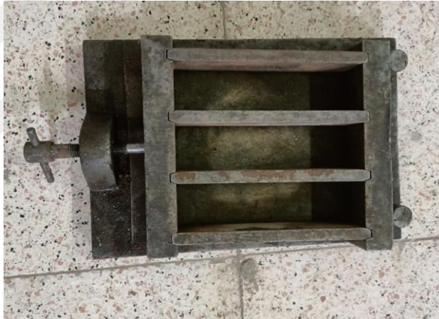
Şekil 6. 4x4x16 cm boyutlarındaki numune kalıpları
