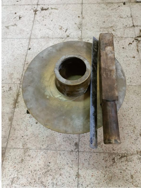
Şekil 8. Yayılma tablası deney düzeneği
