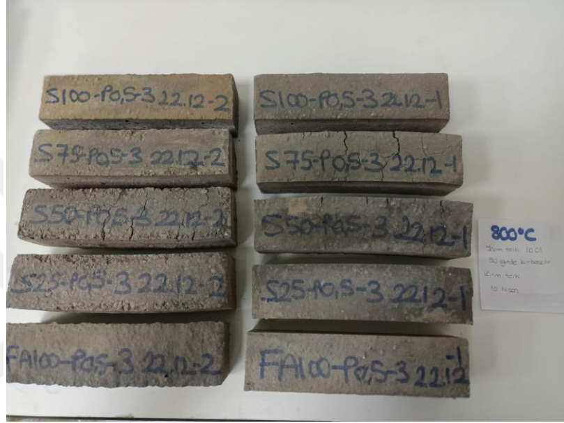
Şekil 45.800°C yüksek sıcaklık sonrası %0,5 polipropilen lif takviyeli numuneler
