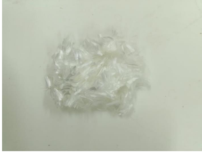
Şekil 5. Polipropilen lifin görünümü
