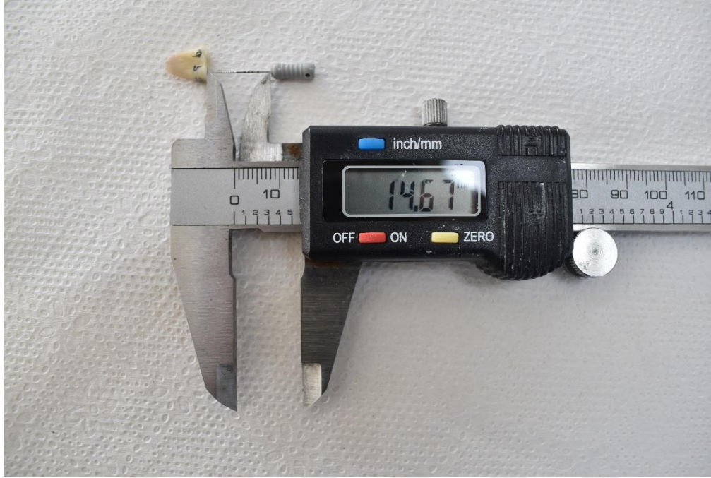
Resim 3.2. Diş üzerindeki referans noktası ile eğenin plastik tutamağı arasındaki mesafenin dijital kumpas ile ölçülmesi
