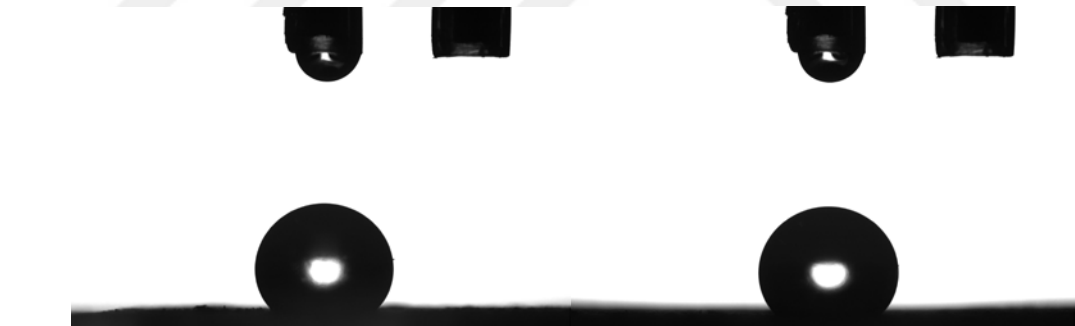
Şekil 5.18 s-SNK yüzey temas açısı ölçümü (2 tekrar verilmiştir.)
