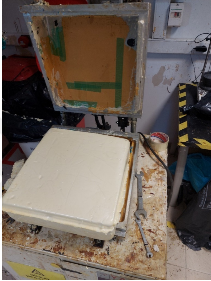
Şekil 4.3 Kurlenme tamamlandıktan sonra kalıptan çıkarılmış olan sert poliüretan köpük (SPK)
