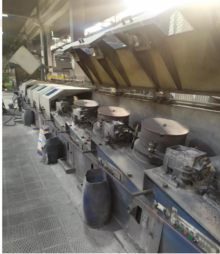
Şekil 2.1 Çelik tel üretimi için kullanılan tel çekme makinası.
