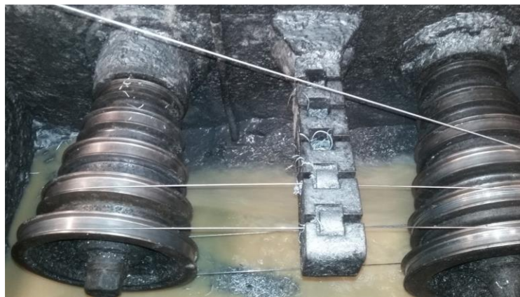
Şekil 1.10 Sulu tel çekme işlemi ve yağlayıcı solüsyonun görüntüsü.
