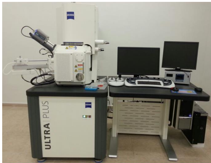
Figure 3.6. Carl zeiss ultra plus gemini fesem.
