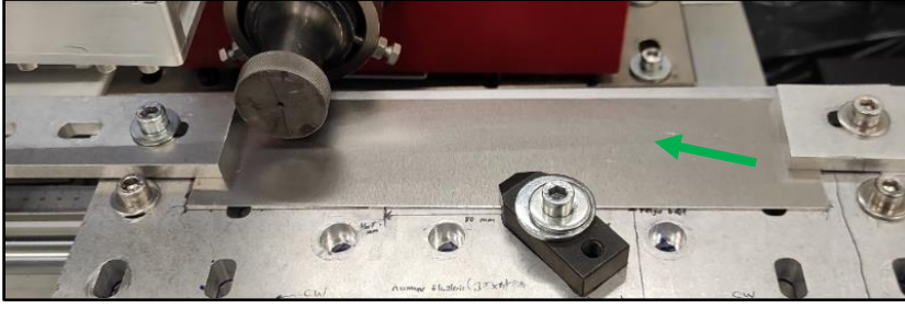
Resim 4.8. 300 mm x 60 mm ebatlarında alüminyum ana plaka
