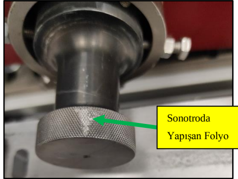
Resim 4.6. Sonotroda yapışan folyo
