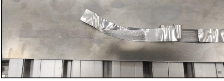
Resim 3.13. Hizalanmadığı için birleşme sırasında kayan folyo
