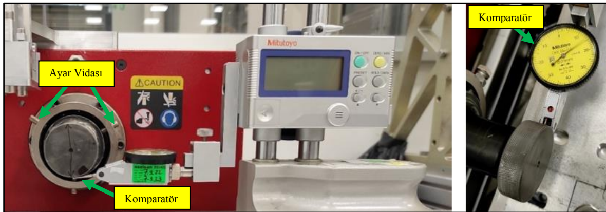
Resim 3.21. Ayar vidaları ve komparatör ile sonotrodun ayarlanması
