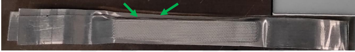
Resim 4.19. Folyo katmanlarının birbirini altında tam hizalanamaması
