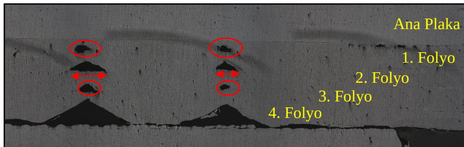
Resim 5.27. Numune-1'de yer alan birleşme hataları-2
