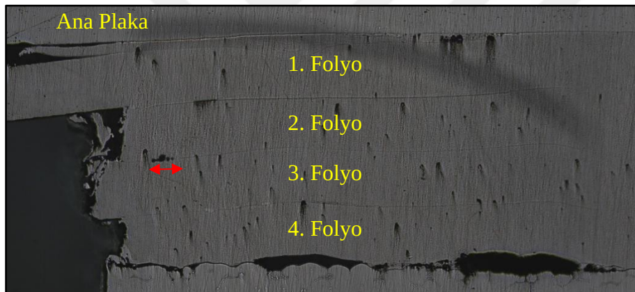
Resim 5.26. Numune-1'de yer alan birleşme hataları-1
