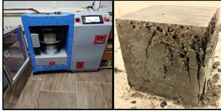
Şekil 4.14 : Basınç dayanımı için test cihazı ve deneye tabi tutulmuş numune.
