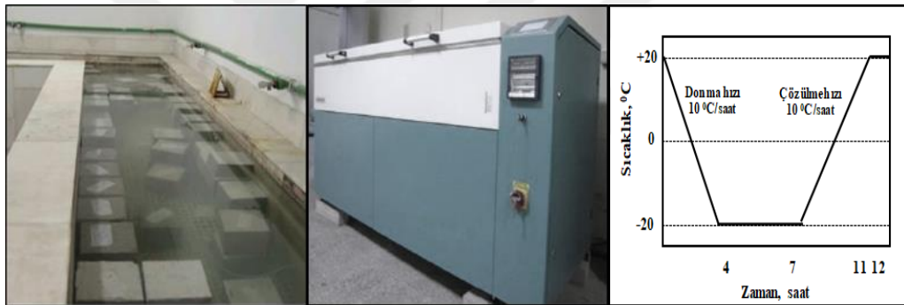
Şekil 3.12 : Üretilen numuneler, donma-çözülme kabini ve çevrimleri.
