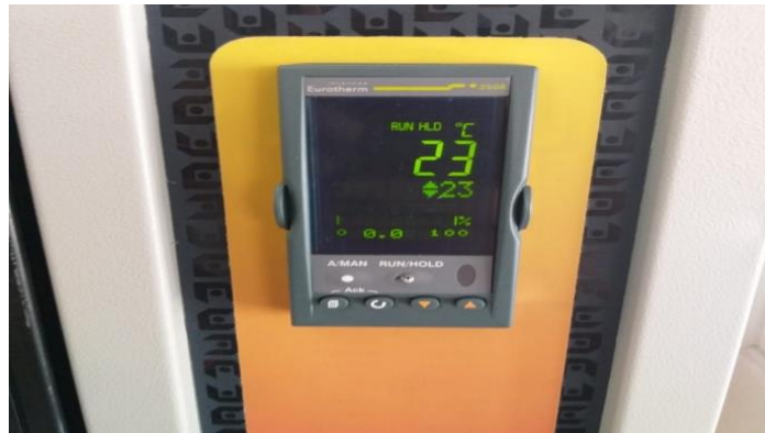
Şekil 5.10. Etüvün programı ayarlanması için ekran kumandası.
