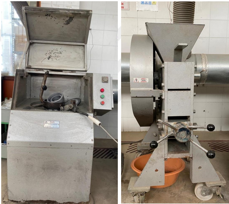
Şekil 5.6. Halkalı değirmen ve çeneli kırıcı.
