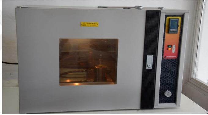
Şekil 5.9. Deney için kullanılan Carbolite markası programlanabilen etüv.
