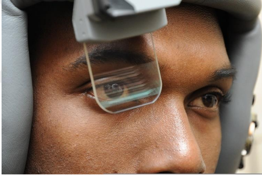
Görsel 116. ABD Hava Kuvvetleri uçuş teknisyeni, kaska monte edilmiş hedefleme sistemi.
