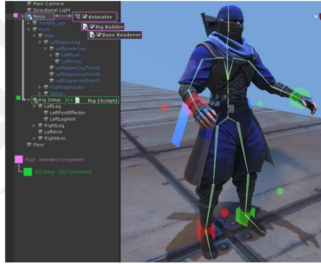
Görsel 76. Unity, 2019. Rigging denetim mekaniği ile kontrol edilebilen iskelet yapısı.
