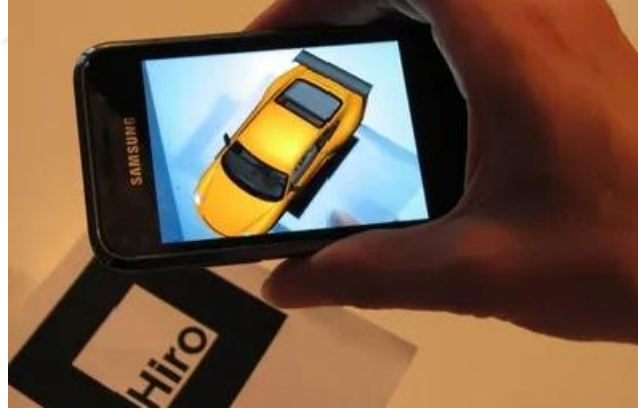
Görsel 132. ARToolKit ile işaretçi sisteminin çalışma süreci.
