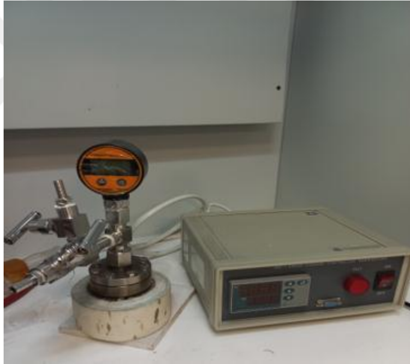
Şekil 3.1 Teflon astarlı paslanmaz çelik otoklav
