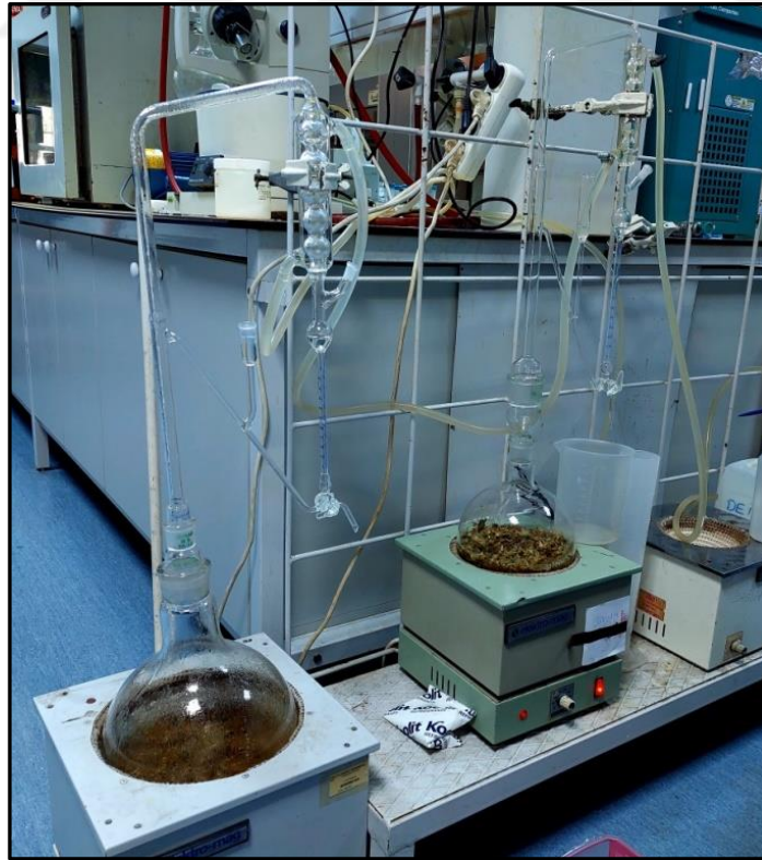
Resim 3: Uçucu yağ eldesinde kullanılan Clevenger düzeneği
