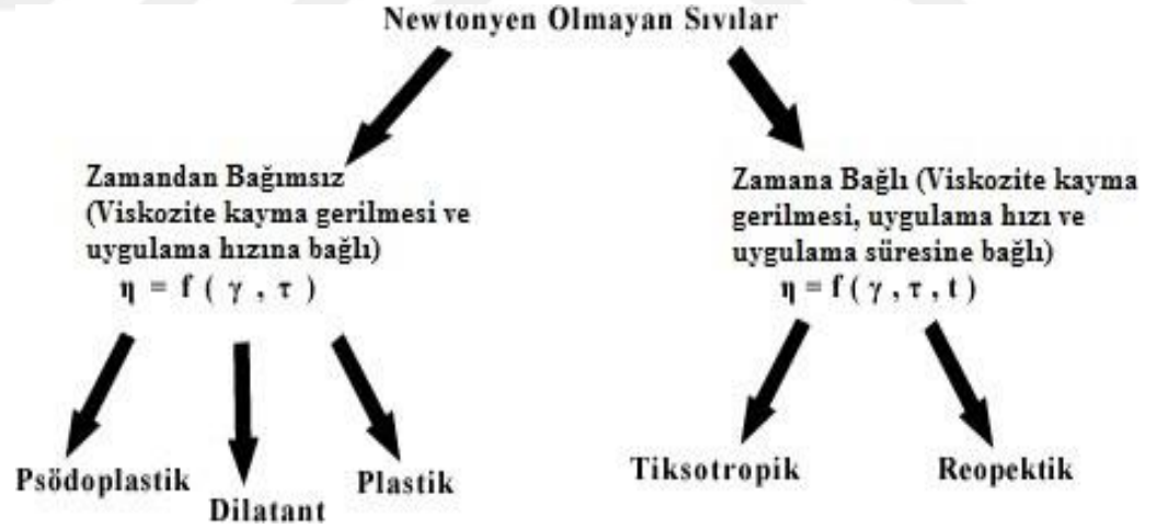
Şekil 4.1 Newtonyen olmayan sıvıların sınıflandırılması (Baradan, 2011).
