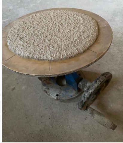
Şekil 6.2 Yayılma çapının tespiti.
