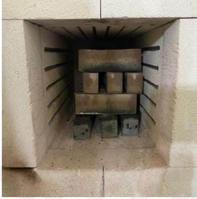
Şekil 6.5 Yüksek sıcaklık fırını ve numunelerin dizilimi.
