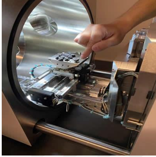
Şekil 6.6 Numuneler'in SEM/EDS test cihazına yerleştirilmesi.
