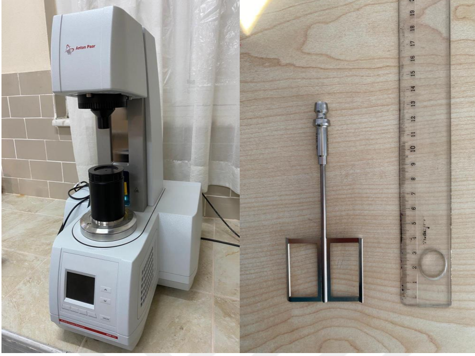
Şekil 6.7 Reometre ve kullanılan uç.
