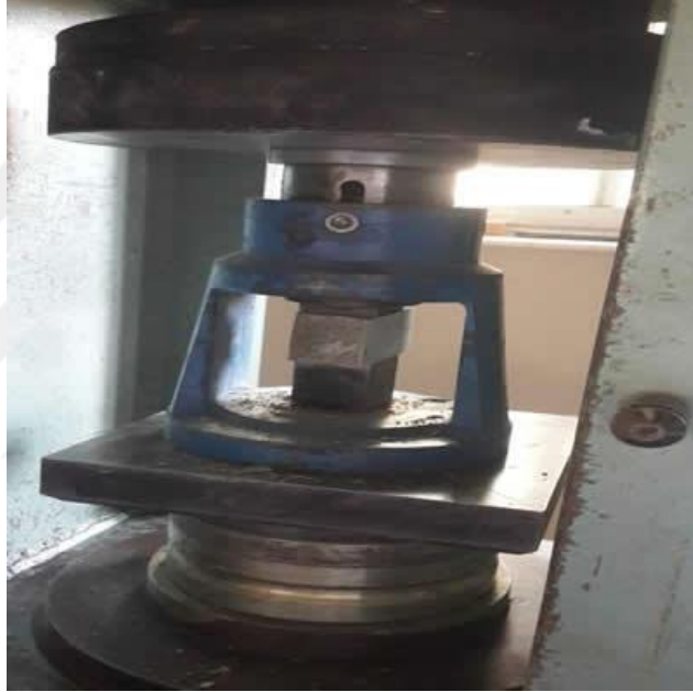
Şekil 6.4 Basınç dayanımı deneyinin düzeneği.
