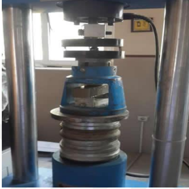
Şekil 6.3 Eğilme dayanımı test cihazı.
