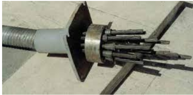
Şekil 7.4. Ankrajın kafası ve kamaların uygulama öncesi görseli ( http://zemincilerbirligi.blogspot.com/ ) (Erişim Tarihi: 28.03.2022).
