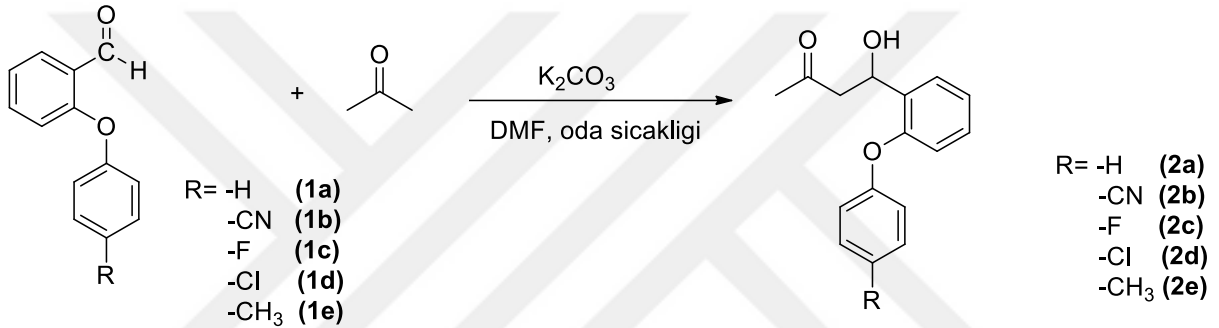
Şekil 3.15: Fenoksi türevi 1,3-keto alkoller için genel reaksiyon şeması.
