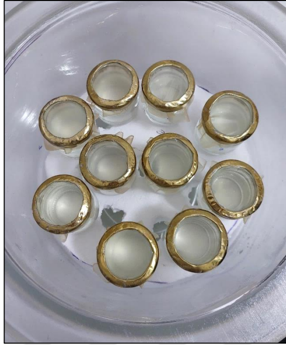
Şekil 3.6. Su buharı geçiş testi için hazırlanan örnekler.
