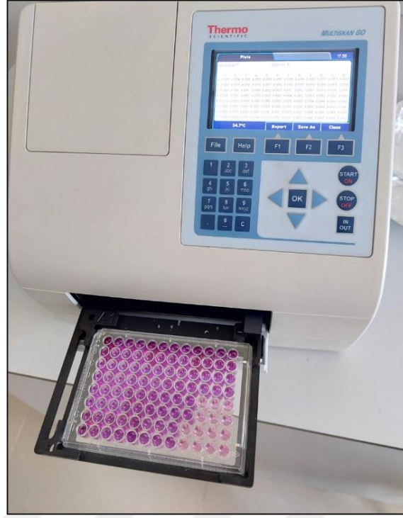
Şekil 3.11. MTT canlılık testi için hazırlanan örneklerin absorbansının bir mikropilaka spektrofotometre cihazında ölçülmesi.
