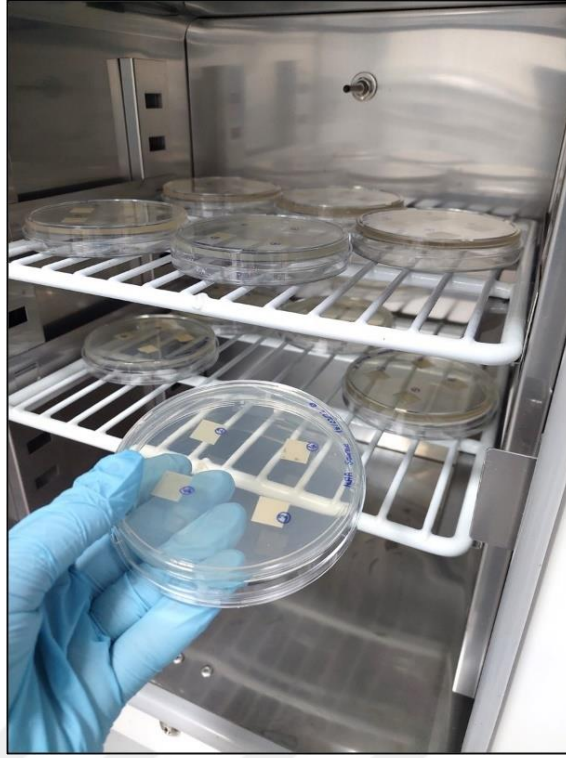
Şekil 3.10. Disk difüzyon testi için hazırlanan ve inkübatöre yerleştirilen örneklerin görünümü.
