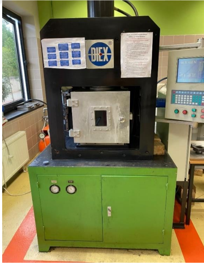
Şekil 5.3. Sinterleme işlemlerinde kullanılan sıcak pres cihazı
