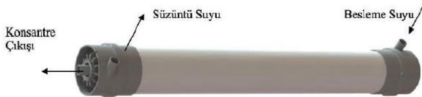
Şekil 2.11: Çapraz akışla çalışan bir içi boşluklu fiber membran modülü [9].
